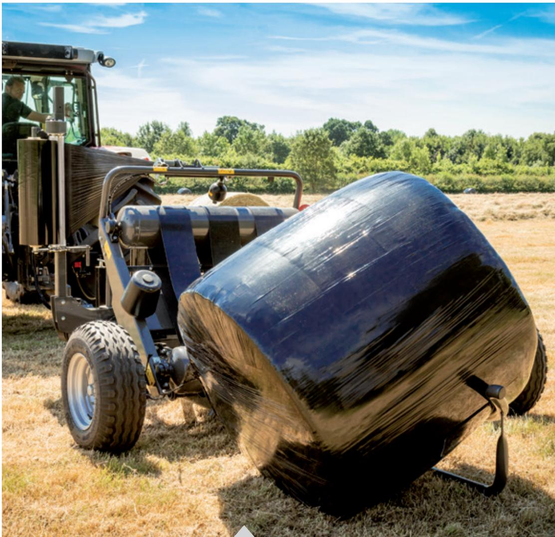
La descarga de las pacas es excepcionalmente cuidadosa y evita el riesgo de dañar el encintado al depositarla en el suelo, gracias a la posición baja de la mesa de encintado, que se inclina hasta casi llegar al suelo al descargar las pacas.
