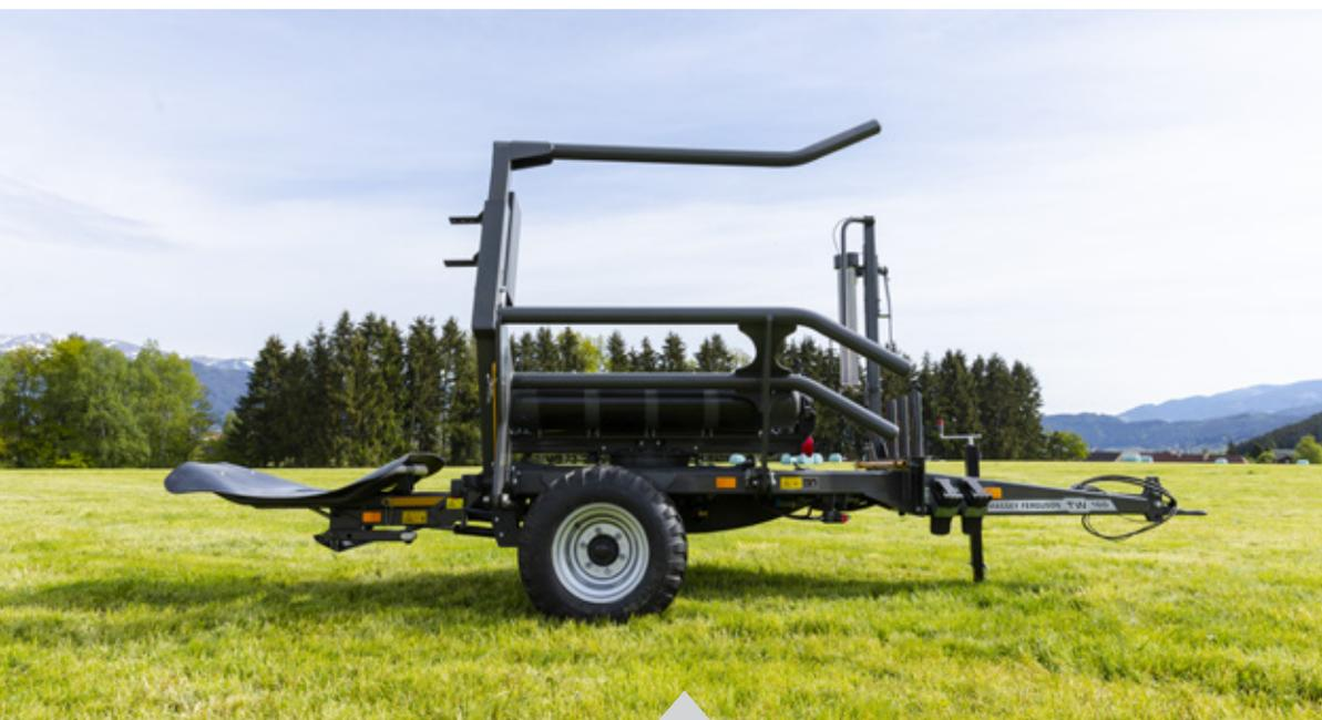
La MF TW 130 y la MF TW 160 son encintadoras sencillas y fáciles de usar, dotadas de un bastidor y una mesa de encintado situada en una posición excepcionalmente baja.
