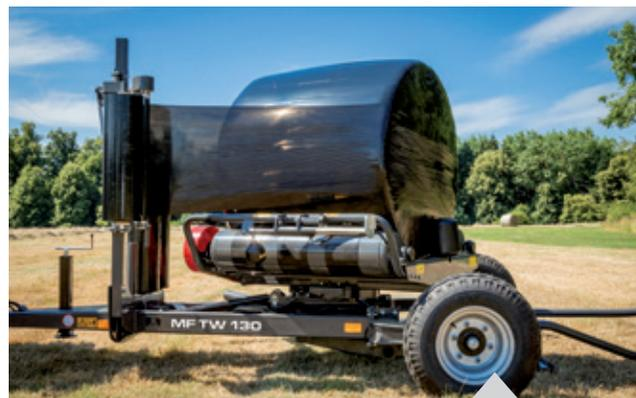
La relación entre la velocidad de rotación de las pacas y la velocidad de la mesa de encintado garantiza un correcto solape de la película. Las guías de la mesa de encintado garantizan que la paca quede firmemente colocada en el centro de la mesa.
