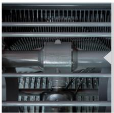
La transmisión Powersplit divide a partes iguales la potencia y la transmite a la unidad del rotor en un lado y a los accionamientos de los rodillos en el otro, lo que permite reducir los requisitos totales de potencia al simplificar las transmisiones. Gracias a ello la rotoempacadora es más eficiente y produce un menor consumo menos combustible.
