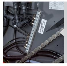
Es extremadamente importante lubricar los rodamientos de forma regular y suficiente, en particular en condiciones adversas, por ejemplo al empacar ensilado. Los puntos de engrase centralizados para la lubricación de los rodamientos de los rodillos están ubicados en posiciones prácticas para ofrecer un acceso más sencillo y reducir el tiempo de mantenimiento.
