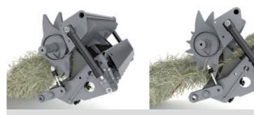
Este sistema de protección patentado evita que los picos de carga se conviertan en bloqueos mediante el descenso suave del suelo que está suspendido sobre bloques de goma o resortes de acero, según el modelo.
