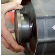
La cámara puede verse sometida a cargas extremas con fuerzas procedentes de todas las direcciones. El inteligente diseño del alojamiento de los rodamientos permite cierto movimiento de los rodillos para eliminar las cargas axiales importantes que se producen durante el funcionamiento.
