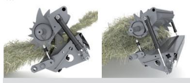
En caso de bloqueo, el operario puede abrir con facilidad el suelo de la mesa de alimentación y bajar las cuchillas al mismo tiempo de forma que haya espacio suficiente para permirtir la salida del material.
