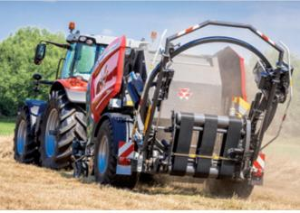
En el modo transporte, el anillo de encintado se pliega hacia delante, reduciendo la longitud total de la máquina a tan solo 5,9 m para una mayor seguridad de transporte y proporcionar una mayor maniobrabilidad.
