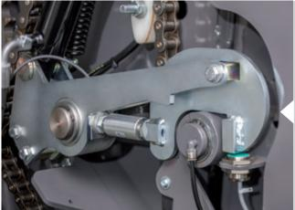
El dispositivo de bloqueo mecánico del portón trasero, sencillo, rápido y eficiente, cuenta ahora con sensores de presión en ambos lados y un indicador izquierda-derecha que permite al operario monitorizar y modificar las capas exteriores de la paca.
