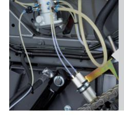
La lubricación automática de las cadenas con ajuste individual para cada cadena garantiza un suministro de aceite suficiente, reduce el tiempo de mantenimiento y amplía la vida útil de la cadena. Para una mayor durabilidad, la empacadora monta unas cadenas de una calidad superior.
