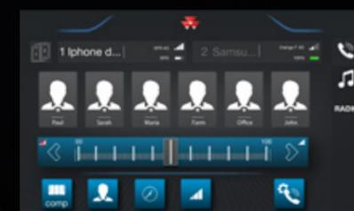
**Acceso a las funciones de la radio a través de Datatronic 5**: es posible conectar dispositivos de manera sencilla a través de Bluetooth, USB o la toma auxiliar, con la posibilidad de sincronizar más de un smartphone, igual que en un coche. Memorice las estaciones de radio, realice y reciba llamadas y mucho más.
