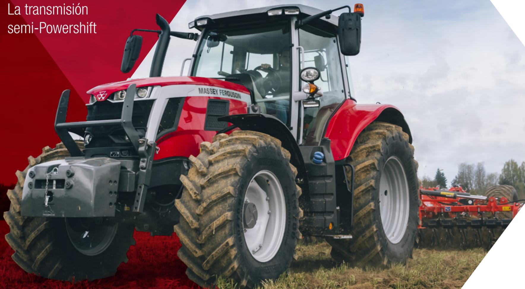
La nueva transmisión semi-Powershift consta de seis relaciones Dynashift dispuestas de manera óptima en cuatro gamas y cambio sin embrague que ofrecen un **rendimiento dinámico y una fiabilidad** incomparables.
