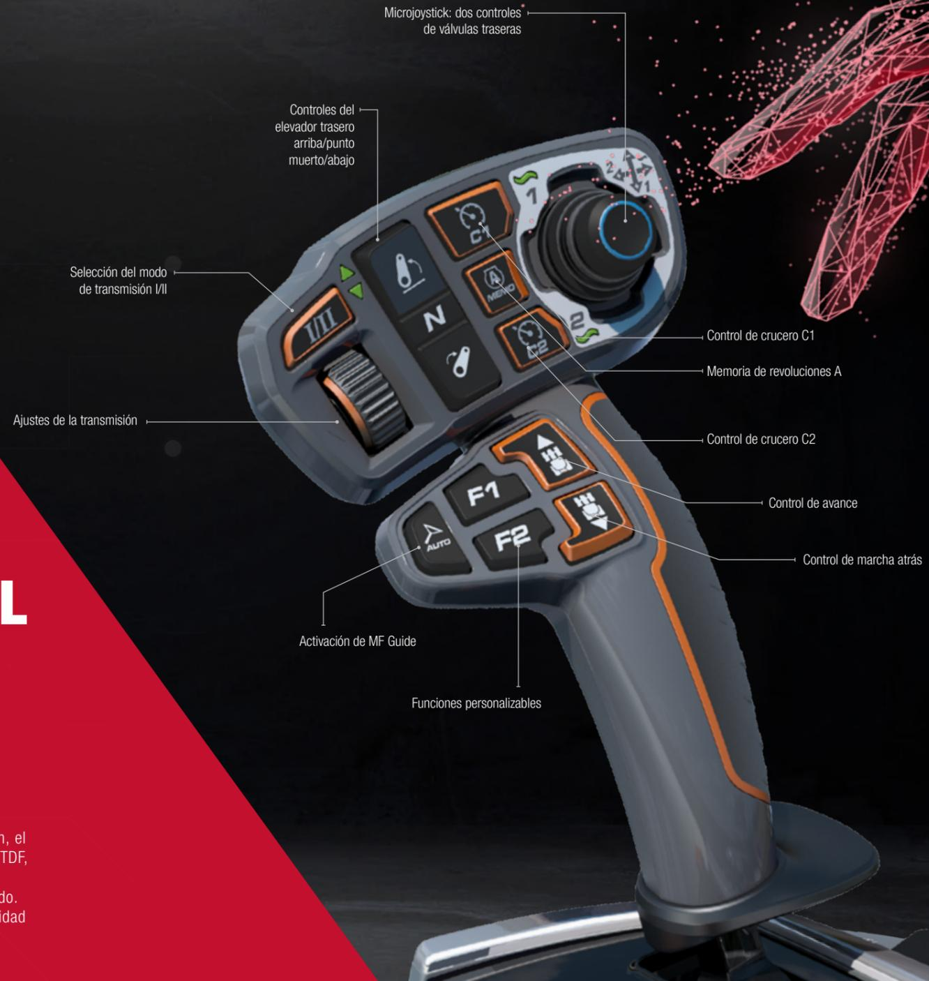
Microjoystick: dos controles de válvulas traseras
