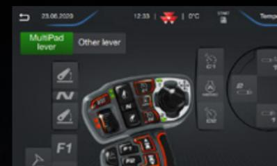
**Asignación de ISOBUS en la palanca MultiPad**. Los aperos ISOBUS pueden controlarse directamente mediante la palanca MultiPad. Tener todos los controles (tractor y apero) en la misma palanca es mucho más cómodo que tenerlos repartidos entre varias pantallas y palancas.
