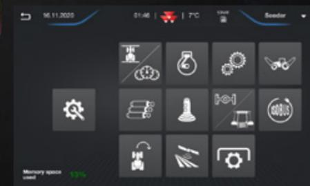
**Gestión completa de las funciones del tractor** y funcionalidades de optimización de la transmisión, el motor y los sistemas hidráulicos. Además, el excelente sistema Dual Control proporciona un magnífico control de los aperos semisuspendidos por medio de la automatización de la entrada y la salida, por ejemplo en las besanas en labores de arado de vertedera. Al mismo tiempo, el sistema ajusta la rueda de control de profundidad del apero en relación con el elevador trasero.
