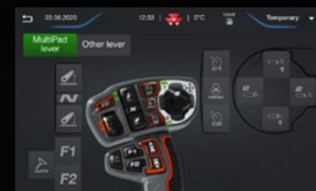
**ASIGNACIÓN DE LOS COMANDOS DEL APERO ISOBUS** en la palanca MultiPad: los aperos ISOBUS pueden controlarse directamente mediante la palanca MultiPad. Tener todos los controles (tractor y apero) en la misma palanca es mucho más cómodo que tenerlos por separado en varias pantallas y palancas.
