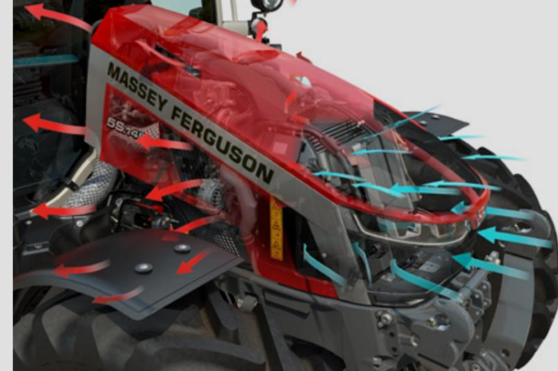
El nuevo sistema de flujo de aire optimizado mejora la refrigeración del motor, aumenta el rendimiento y potencia la eficiencia. Gracias al nuevo diseño de las amplias rejillas, los radiadores acceden sin obstáculos al aire fresco, lo que proporciona la máxima eficiencia de refrigeración.
