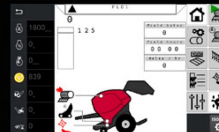
**Control total de los aperos mediante ISOBUS:** el sistema de control del apero se visualiza en la pantalla del terminal, lo que ahorra tiempo y dinero y evita la necesidad de instalar monitores adicionales en la cabina. Basta con conectar el cable del apero en la toma ISOBUS del tractor para que el sistema cargue automáticamente los menús de funcionamiento y los muestre en la pantalla. El sistema ISOBUS del MF 5S cuenta con certificación AEF.
