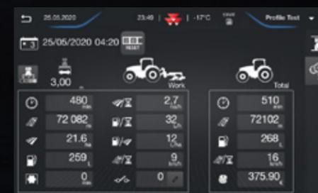
**Memorización de los datos y los ajustes:** el número ilimitado de configuraciones de ajustes de usuario permite registrar durante el funcionamiento información sobre la superficie trabajada, el consumo de combustible, el número de horas trabajadas, etc. El terminal Datatronic permite almacenar todos los ajustes y parámetros. Todos estos ajustes pueden almacenarse y recuperarse para localizar el ajuste previo usado en un tractor.
