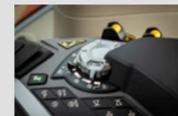
El nuevo sistema de control electrónico del elevador (ELC) proporciona un funcionamiento preciso y ágil de las funciones de elevador, para garantizar un control preciso del trabajo para aperos de suelo y con altura de trabajo para aperos montados.
